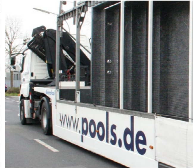
Die Konstruktion wird im Werk und nicht auf der Baustelle gefertigt. Unser Spezialtransporter bringt Ihren Pool hochkant oder quer gefahren an die Baustelle. Auch mehrteilige Becken sind möglich - Fügestellen werden dann vor Ort mit Mosaik überarbeitet.
